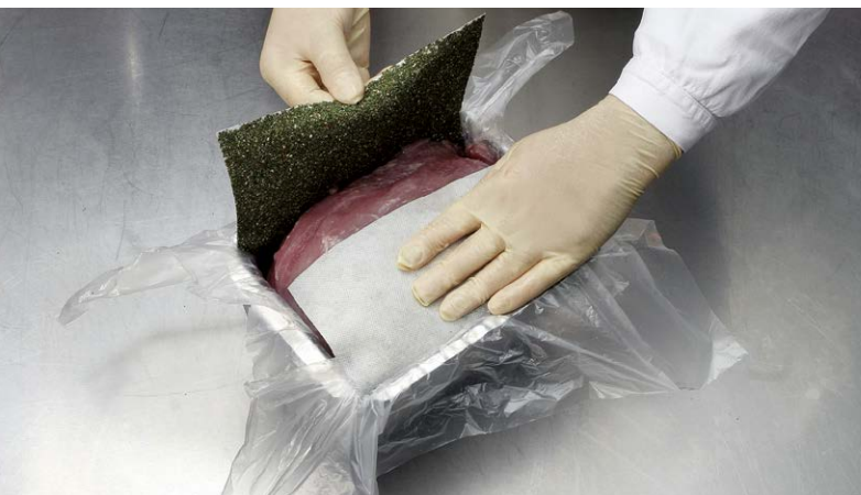
Folie überlappend verschließen, Vakuum ziehen und wie gewohnt weiterverarbeiten.
